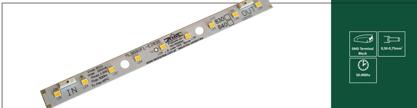
La línea de módulos de LED tipo MLxxR están diseñadas especialmente para el reemplazo de luminarias convencionales. La excelente relación costo-beneficio hace de esta línea de placas una solución ideal tanto para luminarias fijas como dimmerizables.
